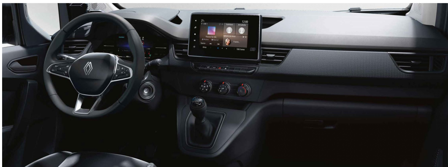
Πίνακας οργάνων οδηγού με οθόνη TFT 3.5" & σύστημα πολυμέσων με ψηφιακή οθόνη 8"
